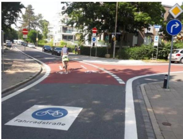
Abb. 11: Beispiel für eine rot eingefärbte Einmündung (Fürth)
